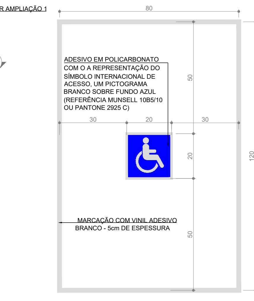
AMPLIAÇÃO 3 - MARCAÇÃO DE ESPAÇO PCD NO PISO
