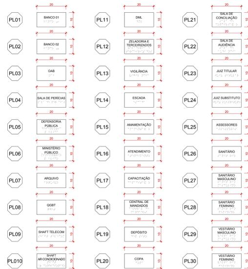
**PLACAS VISUAIS:** Chapa de alumínio anodizado, e=5mm, com adesivo em impressão digital fotográfico.
