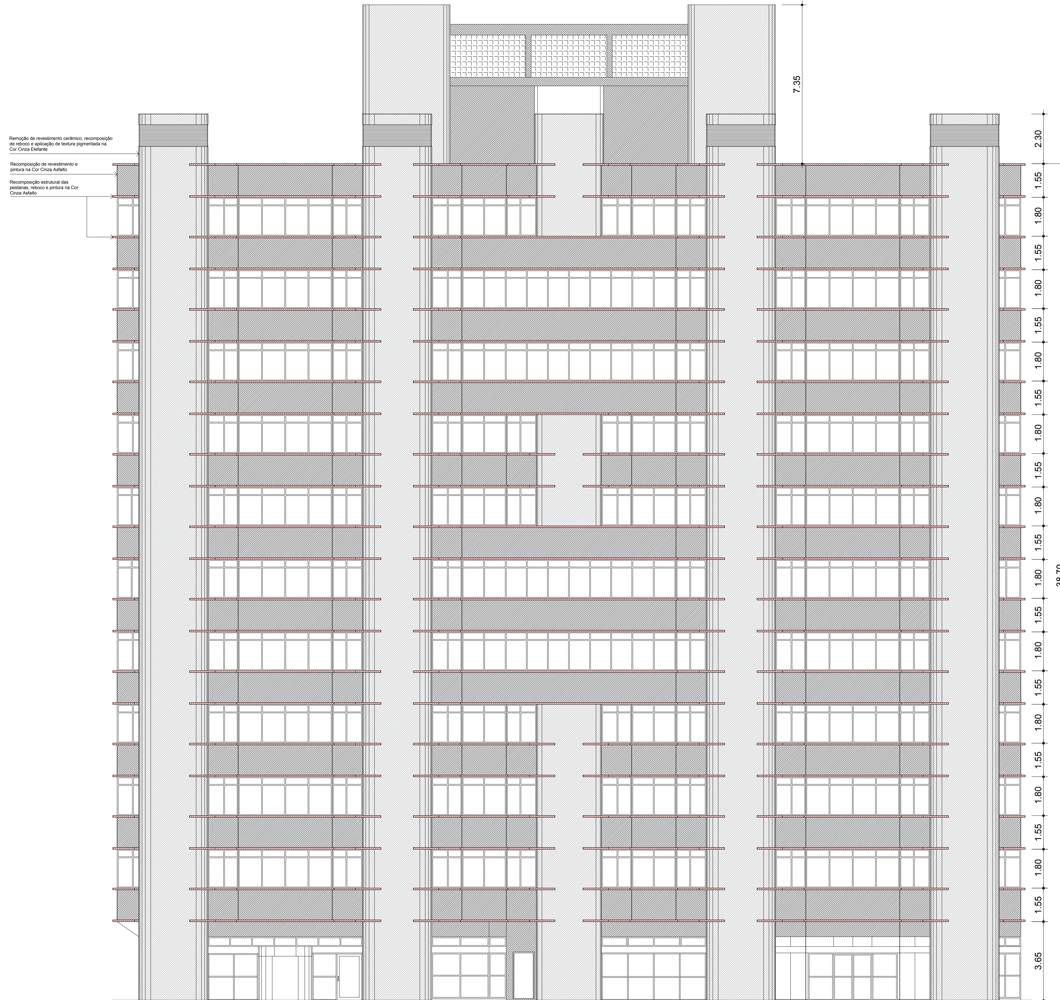
TRT - PRÉDIO SEDE FACHADA OESTE (AV. PRAIA DE BELAS) ESC.: 1/100
